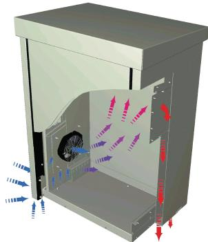
La crescente digitalizzazione ha aumentato enormemente la proporzione di componenti elettronici attivi negli armadi elettronici. I nostri filtri consentono un'efficiente dissipazione passiva del calore, migliorando così la durata dei componenti elettronici.
