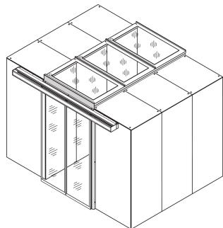
Pannelli di chiusura per diverse altezze di contenimento delle corsie per evitare perdite d'aria nella corsia.
