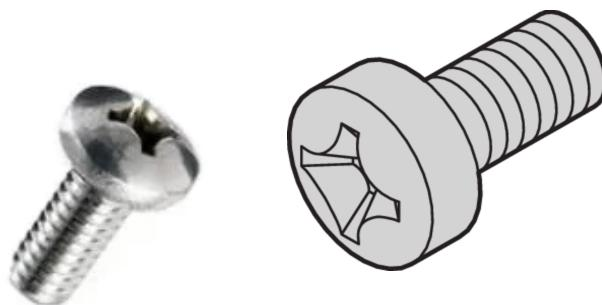
Le viti a testa cilindrica sono un tipo comune di testa non svasata utilizzata per viti autofilettanti, viti autoforanti e viti a macchina. Hanno teste larghe, una superficie di appoggio piatta, verticali elevate, lati smussati o curvi e una superficie superiore piatta o leggermente a cupola con una bussola incassata.
