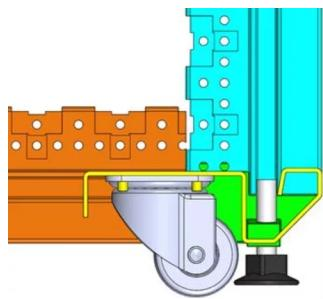
Telaio in acciaio saldato Varistar per requisiti di carico statico. Per l'integrazione di 19", ETSI o piastra di montaggio. Per applicazioni mobili.
