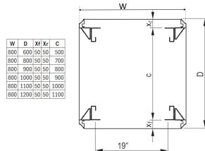
Telaio in acciaio saldato Varistar per requisiti di carico statico. Per l'integrazione di 19", ETSI o piastra di montaggio. Per applicazioni mobili.
