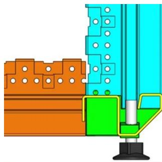
Il telaio saldato Varistar CP è disponibile per i requisiti di carico statico e può essere integrato con 19? ETSI o piastra di montaggio. Inoltre, se necessario, è possibile aggiungere ruote orientabili al telaio.
