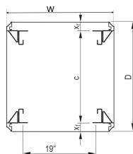
Il telaio saldato Varistar CP è disponibile per i requisiti di carico statico e può essere integrato con 19", ETSI o piastra di montaggio. Inoltre, se necessario, è possibile aggiungere ruote orientabili al telaio.
