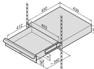
I cassetti da 19" consentono il montaggio di computer portatili e superfici di scrittura per facilitare le operazioni. Il cassetto da 19" SCHROFF ha una capacità di carico di 15 KG, consentendo di assemblare un'ampia gamma di prodotti nel cassetto.
