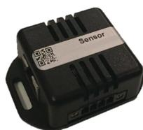
Sensori esterni che monitorano ingressi/uscite digitali con 2 connettori RJ45. È possibile collegare a margherita fino a 16 sensori tramite cavi patch e a una porta Guardian Management.
