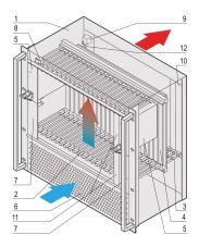
Système CompactPCI 10 U avec PSB pour quatorze cartes 6 U, quatorze cartes RTM et jusqu'à quatre alimentations électriques enfichables 3 U.
