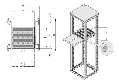
Étagère 19" Varistar, Novastar et Eurorack, avec capacité de charge 70 kg, avec perforations pour faciliter la circulation d'air et la fixation.
