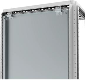
Ce kit de équerres de montage de platines de fixation permet le montage d'une plaque de fixation par l'arrière. Il peut être placé dans l'alignement du châssis de l'armoire ou en retrait derrière le cadre de l'armoire, ce qui augmente la profondeur utile de l'armoire de 20 mm.
