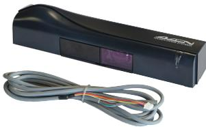
Détecteur de mouvement : Préparé pour le montage sur la boîte de porte, méthode de détection : mouvement, les champs de détection du radar sont réglables, champ large 4 m (L) x 2 m (P), champ étroit 2 m (L) x 2,5 m (P), tension d'alimentation 12 ... 24 VAC ou 12 ... 30 VDC, alimentation en courant par le connecteur sur la plaque de porte.
