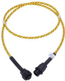
Cet ensemble de détection de fuites étend le Varistar LHX+ 45 In-Rack et le RackChiller In-Row 45 avec la capacité de détecter les fuites à l'intérieur de l'appareil. Le capteur à câble est installé sur le bord du bac à condensat pour minimiser les fausses alertes dues à l'eau de condensation ou à d'autres facteurs similaires.
