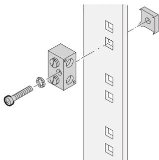
Ces bornes de mise à la terre mécaniques sont conçues pour le raccordement câble-barre dans les systèmes de mise à la terre et de mise à la masse. La borne de mise à la terre Schroff permet une section de 100 mm<sup>2</sup>.
