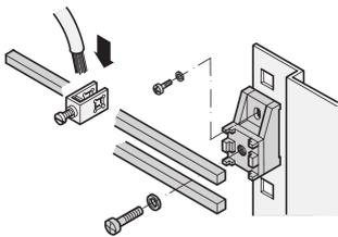
Bornes de raccordement de différentes sections, selon les besoins du client .
