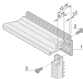
Bande d'adaptation en Z pour connecteur conforme à la norme EN 60603-2 (DIN 41612).
