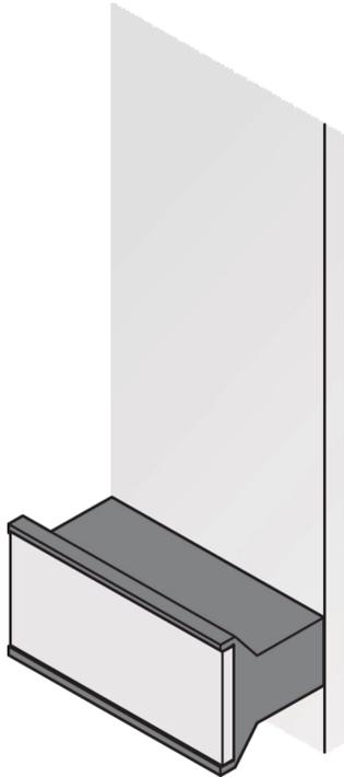
La poignée statique en matière plastique, de forme trapézoïdale et de couleur noire, peut être montée sur une face avant pour faciliter l'extraction de la carte.
