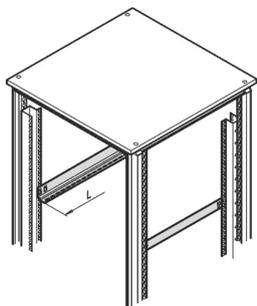
Visserie pour fixation des glissières entre les montants avant et arrière, pour supporter les composants 19" lourds. Glissières avec perforations latérales pour la fixation d'accessoires et la circulation d'air.
