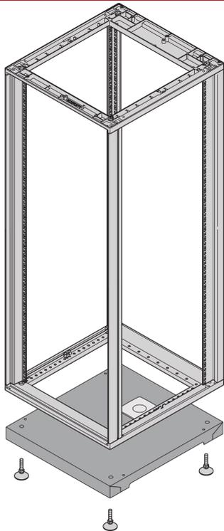
Tôle plancher avec découpe pour passage de câble.
