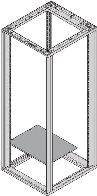
La tôle plancher est une plaque d'obturation en acier installée sur la base de la baie. Limite la circulation d'air dans la baie depuis le bas, elle peut être ouverte pour le passage de câbles
