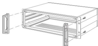
Les poignées avant peuvent être montées sur les coffrets Inpac et permettent un montage plus facile du coffret dans une armoire. Les trous qui permettent le montage des poignées doivent être percés par l'utilisateur.
