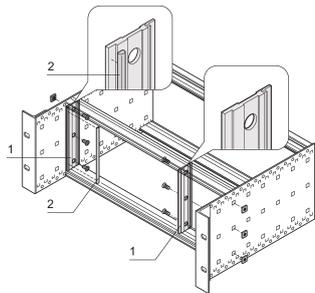
Pour blindage vertical CEM textile entre des faces avant montée en retrait et le flanc.
