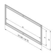
L'installation du cadre avant permet le contact entre les bacs à cartes et les montages. Il doit être utilisé si un client a sélectionné un kit de montage de carte horizontale.
