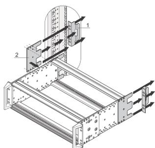
Prolongateur pour la fixation arrière d'un bac à cartes conformément à la norme DL3 dans une armoire. Garantit une résistance aux chocs et aux vibrations jusqu'à 25 g.
