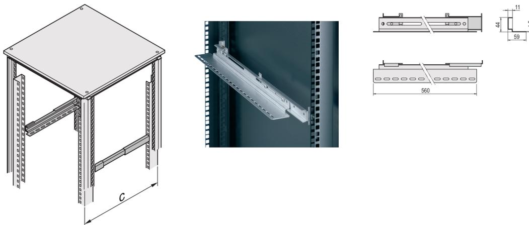
Glissière fixe Eurorack avec 40 kg de capacité de charge pour fixation sur les montants des baies ou 19". La glissière fixe soutient les châssis 19" lourds.
