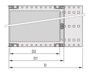
Profilé horizontal arrière pour montage des cartes fond de panier avec bande isolante
