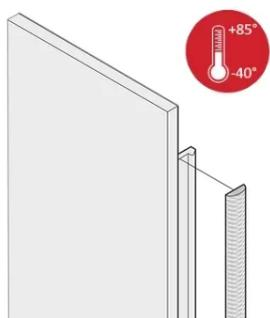
Les joints CEM en textile sont positionnés dans un emplacement à droite des faces avant en U. Les joints sont collés sur la face avant. Pour une plage de températures étendue jusqu'à +85°C.
