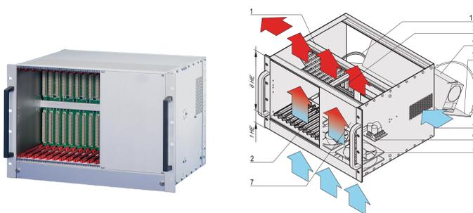
Système VME pour 12 cartes VME 6 U, 160 mm. L'alimentation du système est fournie par une alimentation open frame. Un module de régulation du ventilateur surveille les ventilateurs, la température et la tension.
