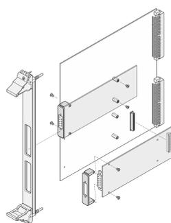
Face avant en U avec découpe pour PMC. Possibilité de blindage avec joint CEM textile.
