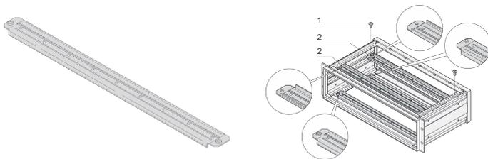
La glissière de support permet le montage des guide-cartes. En conjonction avec une glissière en Z, des connecteurs DIN peuvent être montés. Une carte fond de panier peut être assemblée directement sur la glissière si un insert fileté est utilisé.
