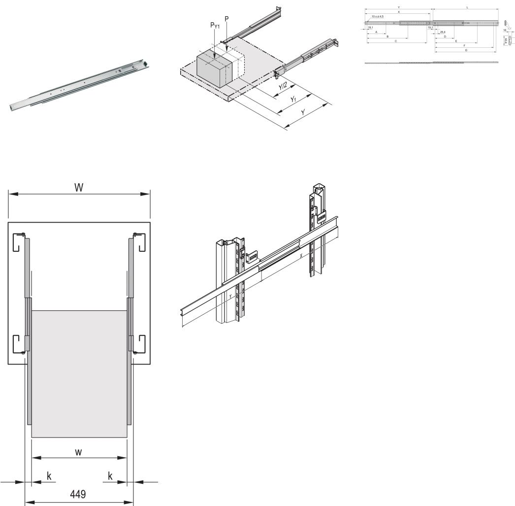
Glissière télescopique universelle avec extension > 100 % et jusqu'à 61 kg de capacité de charge.
