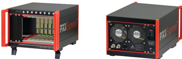
Le système nVent SCHROFF PXIe 8 slots dispose d'un slot système 16 F avec une configuration 4 liaisons. 3 des slots périphériques hybrides sont connectés par des liaisons PCIe Gen 3 avec 4 voies. Les 4 slots périphériques hybrides restants sont connectés par des liaisons PCIe Gen 2 avec une voie chacun.
