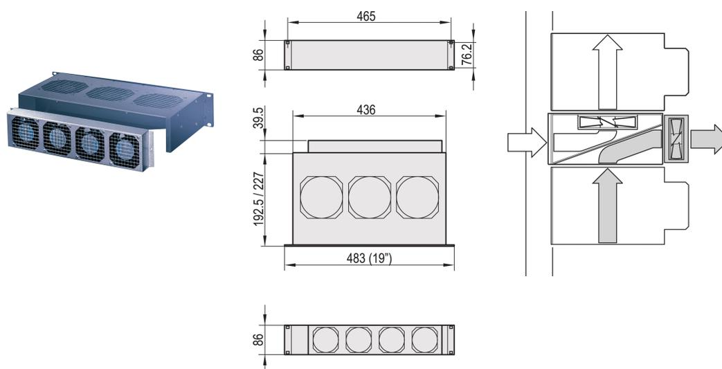
Ventilateur supplémentaire (intégré) avec logement pour ventilateur-poussoir Schroff 2 U. Aucune tension d'alimentation supplémentaire n'est nécessaire : la connexion se fait par le ventilateur-poussoir 19".
