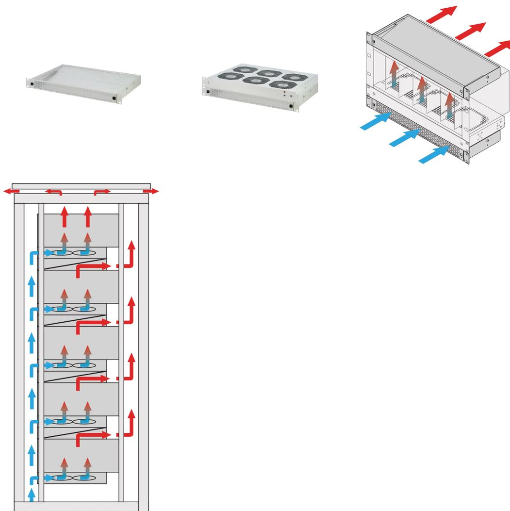
Déфлектор d'air de hauteur 1 U pour guider l'air de l'avant vers le haut ou du bas vers l'arrière.
