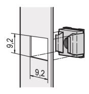
Les écrous-cages autorisent un large choix de tailles d'écrous et de vis et sont faciles à remplacer, contrairement aux trous pré-filetés. Les écrous-cages sont faciles à utiliser sur des matériaux trop fins ou souples pour être filetés.
