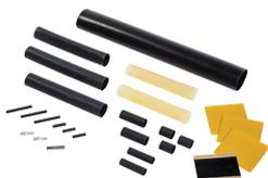
Le modèle nVent RAYCHEM TE-01-CR est un kit thermorétractable de polymère utilisé pour connecter jusqu'à trois câbles chauffants de traçage électrique autorégulants nVent RAYCHEM et effectuer une jonction, une dérivation, et une terminaison. Nécessite un dénudage des fils et un pistolet thermique. Le kit contient les matériels requis pour effectuer une jonction et une terminaison, ou une dérivation en T et une terminaison.
