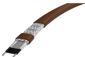
Les câbles chauffants de traçage électrique autorégulants nVent RAYCHEM QTVR conviennent parfaitement aux applications de mise hors gel des longs circuits de tuyauteries et des grands réservoirs présentant d'importantes déperditions de chaleur et les applications de maintien de la température de process jusqu'à 225 °F/110 °C ne nécessitant pas de nettoyage vapeur. La gaine extérieure en polymère fluoré (-CT) offre une résistance chimique élevée contre les agents organiques et produits corrosifs.
