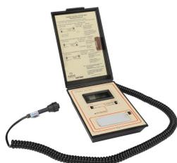
nVent RAYCHEM TraceTek TT-PTB-1000 est un dispositif portable alimenté par batterie permettant de tester des longueurs individuelles de câble de détection, jusqu'à 1 000 m / 2 000 pi. Utile pour l'installation et l'entretien de systèmes étendus.
