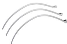
La gamme de colliers en acier inoxydable nVent RAYCHEM PBxxx est spécialement conçue pour maintenir les câbles chauffants à isolant minéral (MI) sur la conduite. Les pinces sont le seul outil nécessaire pour tirer la bande de fixation. La boucle et la bande évitent la surtension du câble chauffant et éliminent les défaillances de fatigue causées par les cycles de dilatation et de contraction en fonctionnement.
