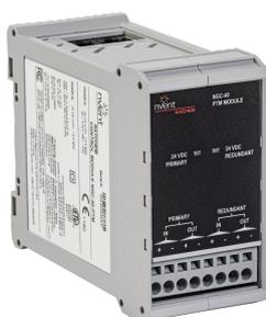
Le module de terminaison d'alimentation nVent RAYCHEM NGC-40 accepte une entrée d'alimentation primaire et redondante, les entrées de bus CAN et assure le raccordement du bus CAN. Chaque NGC-40-PTM peut alimenter un maximum de 10 modules NGC-40.
