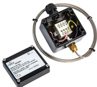
Le nVent RAYCHEM MONI-PT100-EXE est un détecteur de température de résistance (RTD) en platine à trois fils, fourni avec une boîte d'accouplement en polycarbonate renforcé de fibre de verre. Convient aux zones explosibles.
