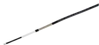
Les câbles chauffants de traçage électrique autorégulants nVent RAYCHEM ETL assurent une mise hors gel de tuyauteries éco-énergétique. Les modèles R-ETL-A/B conviennent aux applications sur ou internes aux tuyauteries. R-ETL(-A/B)-CR, quant à lui, convient aux applications sur tuyauterie uniquement. Ils sont tous deux disponibles avec deux puissances de sortie (10 et 16 W/m à 5 °C), et sont pris en charge par une gamme complète de raccordements et accessoires thermorétractables.
