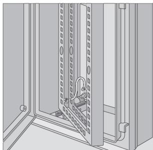
Le dispositif de mise à la terre fournit un moyen d'attacher un conducteur de mise à la terre à un panneau ou un châssis pivotant Ultrix. Comprend le matériel et les instructions d'installation.
