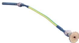
Les ponts de mise à la terre sont des ensembles faits d'un point de mise à la terre de qualité supérieure (borne de connexion) et de divers types de conducteurs. Le processus de connexion exothermique nVent ERICO Cadweld sert à les combiner pour former un ensemble durable et hautement résistant à la corrosion.
