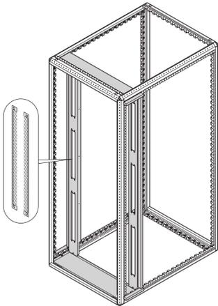
Joint balai pour fermer les découpes 2 U 19" des bandeaux d'obturation d'air. Trou de montage carré avec écrous cage.
