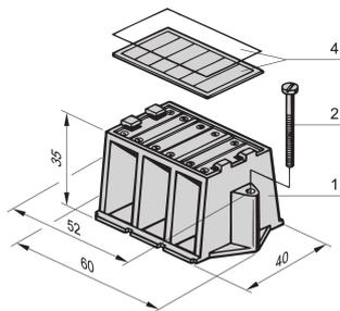
Les équerres de montage pour barres bus ou les modules de barres bus sont des unités de montage isolées du circuit de charge pour les traverses de mise à la terre. Il peut y avoir des adaptateurs avec des courants nominaux assignés qui peuvent fournir du courant de charge aux dispositifs par le biais de connexions filaires.
