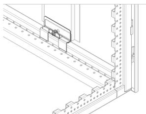
Le dispositif de maintien interne est facilement fixé sans perçage et permet de retirer la face arrière seulement de l'intérieur. Le dispositif de maintien est uniquement pour les applications IP 20.
