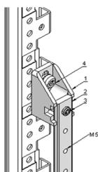
Barre de cuivre généralement logée à l'intérieur de l'appareillage électrique, des panneaux de commandes et des boîtiers de bus pour la mise à la terre. Elles sont également utilisées pour connecter les équipements de haute tension dans les postes de commutation électrique, et les équipements de basse tension dans les groupes de batteries.
