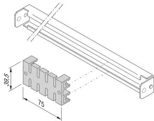
Les rails C facilitent la gestion du câblage. Installation généralement derrière les montants 19". Ils sont compatibles avec les serre-câbles standard.
